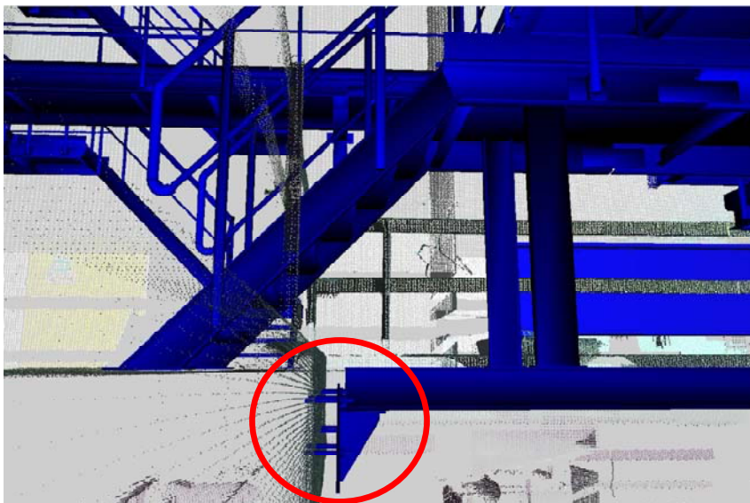
Figur 9: Eksempel på visuel kontrol mellem punktsky af eksisterende bygning (vist med grå) og den projekterede løsning (blå). Som anskueliggjort inden for den røde cirkel er der en uoverensstemmelse mellem den projekterede løsning og den eksisterende bygning.
