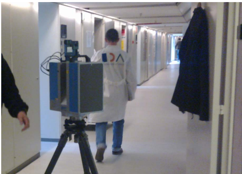
Figur 6: 3D laserscanner anvendt til rumlig registrering.
