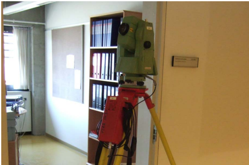
Figur 5: Totalstation anvendt til traditionel opmåling af eksisterende bygninger.
